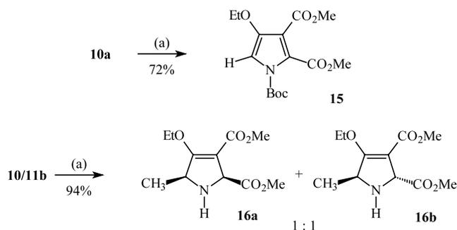
Scheme 5. (a) DDQ, toluene, reflux 16 h; (b) CF<sub>3</sub>COOH, DCM, 2 h.
