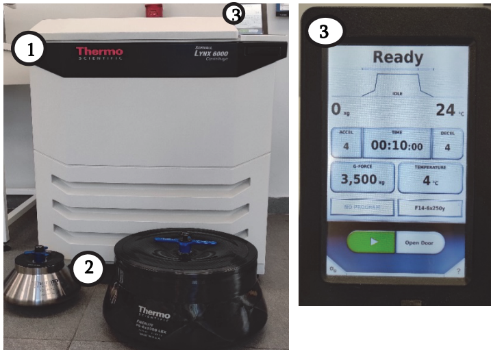
Նկ. 7. 1. Thermo Fisher Scientific Sorvall Lynx 6000 մակնիշի լաբորատոր ցենտրիֆուգ, 2. ռոտորներ, 3. կառավարվող վահանակ
