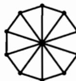
Приведем доказательство для первого примера. Если вышли из строя два узла на одном пятиугольнике, то связь сохранится через другие пятиугольники. Если вышли из строя по одному узлу на разных пятиугольниках, то связь сохранится по линиям, соединяющим эти пятиугольники.
