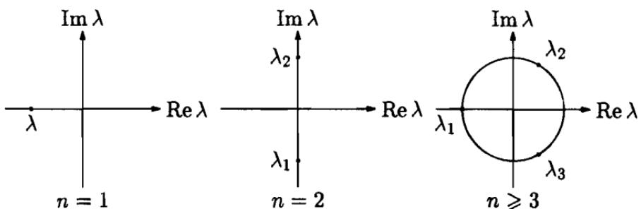
Рис. 10. Неустойчивость многоступенчатого управления.
