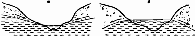
Նկ. 16. Գետի ջրի և գետնաչրի կապը հովտի լայնակի կտրվածքում. ա — գետնաչրից հոսք դեպի գետ, բ — գետից հոսք դեպի գետնաչուր:
