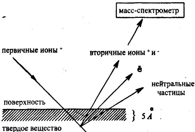
Рис. 8. Упрощенная схема спектроскопа SIMS.
