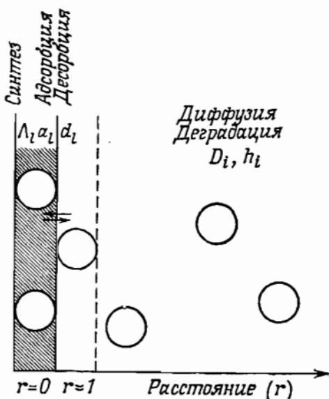
Рис. 59. Схематическое представление модели гетерогенной реакции с участием гиперциклической связи. Выделены три пространственные области:  $r = 0$  — поверхность раздела,  $r = 1$  — пологий слой у поверхности раздела,  $r > 1$  — объем раствора. На химические реакции, протекающие по схеме гиперцикла, накладывается диффузия к поверхности раздела и обратно.
