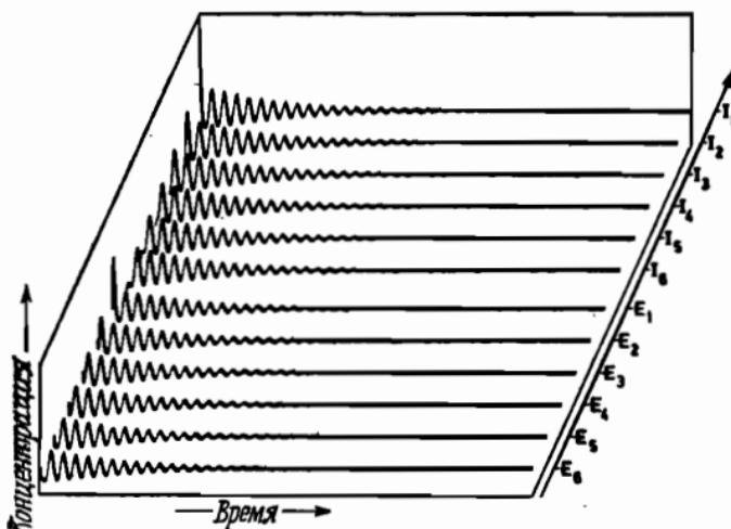
Рис. 38. Интегральные кривые динамической системы, соответствующей гиперциклу с трансляцией. Размерность  $2 \times 6$ ,  $K = 0,25$ ; начальные условия:  $y_1(0) = 5,0, y_2(0) = \dots = y_6(0) = 0,5; x_1(0) = \dots = x_6(0) = 1,0$ ; полная концентрационная шкала = 5 единицам концентрации, полная временная шкала = 1000 единиц времени. Значение константы равновесия  $K$  находится ниже критического уровня для бифуркации Хопфа; следовательно, наблюдаются затухающие колебания.
