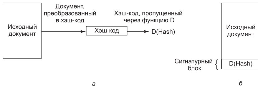
Рис. 9.2. Вычисление сигнатурного блока (а); то, что приходит получателю (б)
