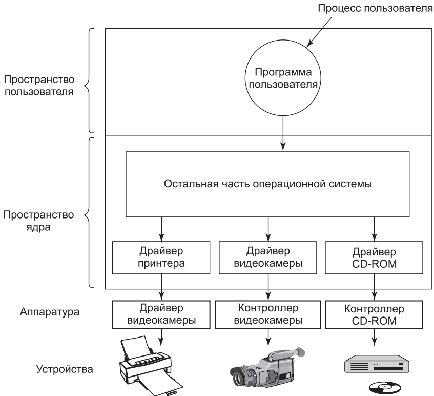
Рис. 5.10. Логическое позиционирование драйверов устройств. На самом деле весь обмен информацией между драйверами и контроллерами устройств осуществляется по шине
