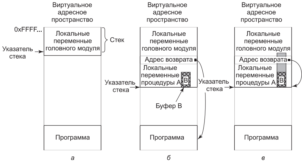
Рис. 9.22. Складывающиеся ситуации: при работе основной программы (а); после вызова процедуры A (б); при переполнении буфера, показанного серым цветом (в)
