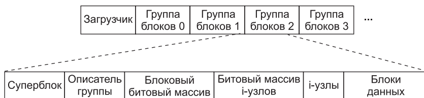
Рис. 10.17. Размещение файловой системы ext2 на диске
