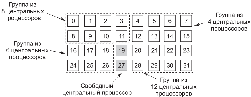
Рис. 8.13. Набор из 32 центральных процессоров, разбитый на четыре секции с двумя свободными процессорами
