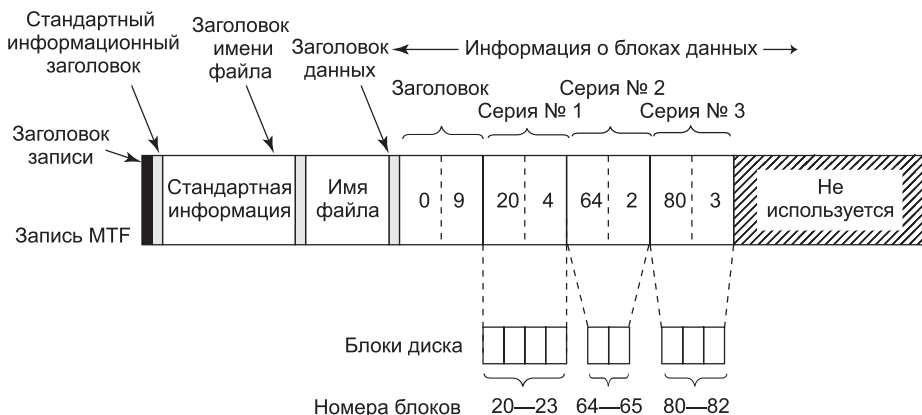
Рис. 11.25. Запись MFT для потока из трех участков и девяти блоков
