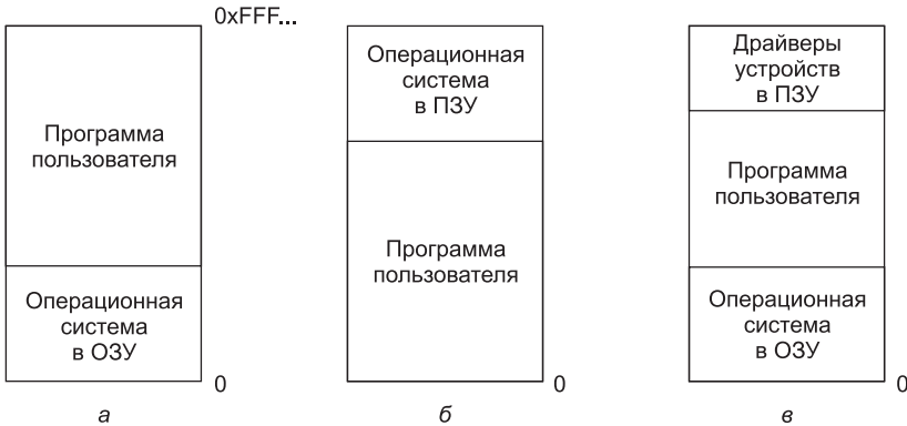
Рис. 3.1. Три простых способа организации памяти при наличии операционной системы и одного пользовательского процесса (существуют также и другие варианты)
