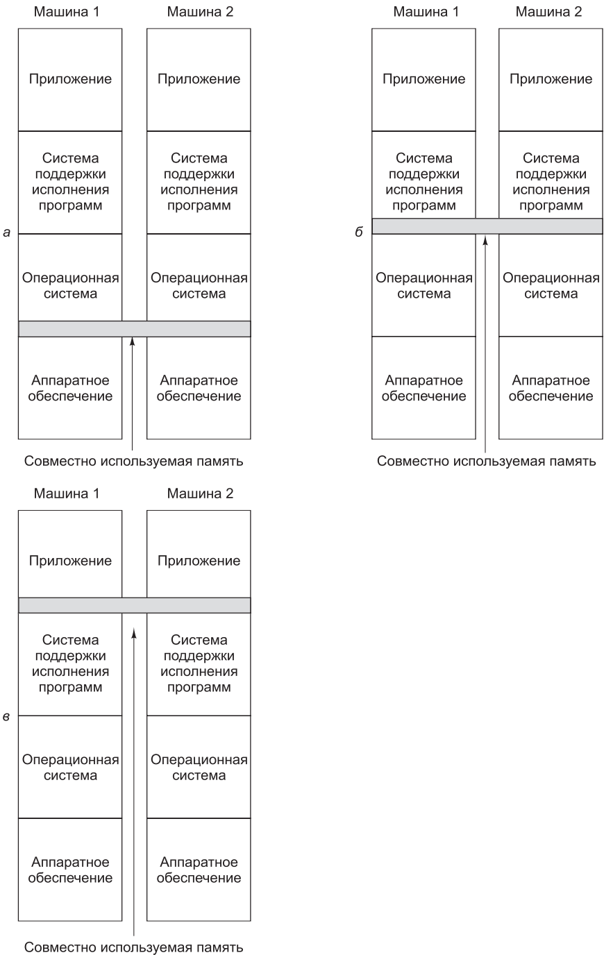
Рис. 8.21. Различные уровни реализации совместно используемой памяти: на аппаратном уровне (а); на уровне операционной системы (б); на уровне программного обеспечения пользователя (в)
