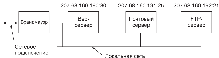
Рис. 9.27. Упрощенный вид аппаратного брандмауэра, защищающего сеть из трех компьютеров
