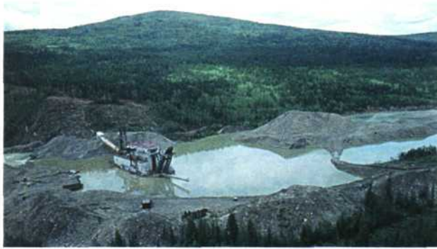
Для получения россыпного золота требуется промывать многие кубометры песка. Это делают с помощью драги
