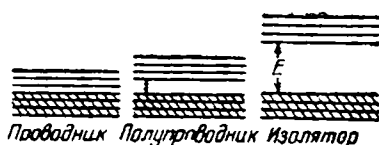
Рис. III-65. Схема расположения зон в различных веществах.
