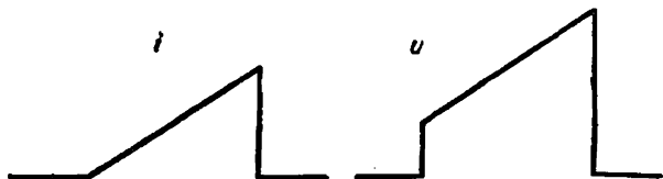
Рис. 8.12. Формы тока и напряжения, необходимые для линейного отклонения луча в электронно-лучевой трубке с магнитным отклонением
