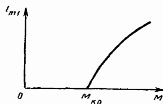
Рис. 13.12. Мягкий режим возникновения генерации
