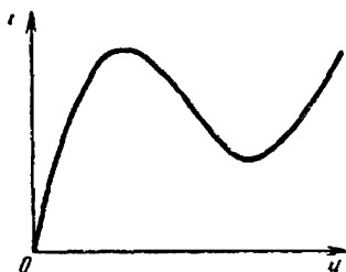
Рис. 13.19. Вольт-амперная характеристика с падающим участком
