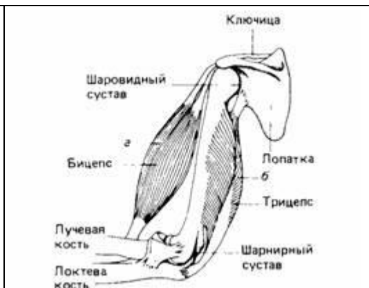
Рис. 11.6. Механическое сопряжение мышц и скелета в руке человека. Мышцы лежат снаружи скелета. Мышца а - сгибатель, мышца б - разгибатель.
