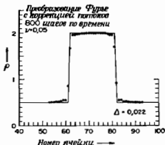
Фиг. 4 Использование оптимального алгоритма преобразования Фурье с коррекцией потоков для решения пробной задачи о прямоугольном импульсе.
