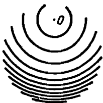
Рис. 13.5. При наличии плоскопараллельной пластинки светлое пятно на экране изрезано интерференционными полосами
