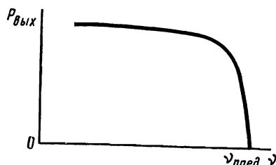
Рис. 4.1 Типичная зависимость выходной высокочастотной мощности триода от частоты
