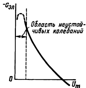
Рис. 7.19. Характер зависимости активной электронной проводимости магнетрона от амплитуды СВЧ колебаний при B = \text{const}
