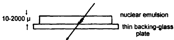
Նկ. 4.88. Միջուկային էմուլսիաներով չափումներ կատարելու մեթոդը:
