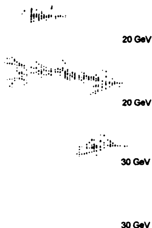
Նկ. 7.42. ա) 20 և 30 ՉէՎ էներգիայով հաղորդնային հեղեղների թվայնացված պատկերը առկայծող խցով կալորիմետրում /560,561/:
