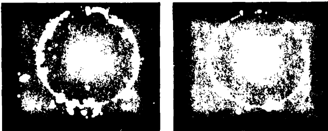
Նկ. 6.18. Մի մասնիկի էՀՄ-ով վերականգնված Չերենկովյան օղակը (աջ), և 10 համուղղված դեպքերի վերադրումը (ձախ): Օղակները գրանցվել են բազմականալ թիթեղի օգնությամբ /456/:
