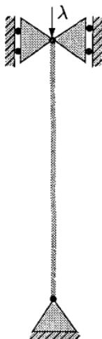
Изучение устойчивости упругих конструкций опирается на простейшие эталоны. Один из них — задача об устойчивых формах шарнирно-закрепленного стержня единичной длины и переменной жесткости  $\rho(s)$  в случае продольной нагрузки  $\lambda$ .
