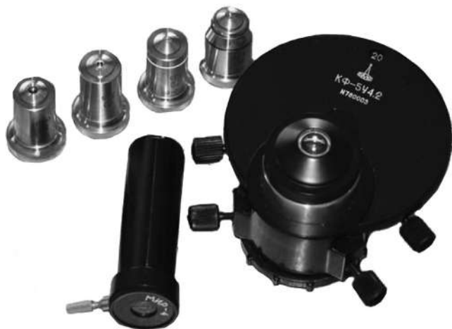
Նկար 27. Փուլացայտերանգային հարմարանքի օպտիկական համակարգը:
