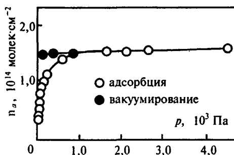
Рис.7.6. Адсорбция кислорода на атомарно-чистой поверхности графита
