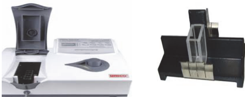
Նկ. 2.19 Լուսաէլեկտրագունաչափ (ԼԷԳ), գունաչափման կյուվետ:
