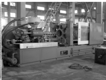
Նկար 7.5. Ներարկումով կաղապարման սարքի ա) գծապատկերը և բ) արտադրական պատկերը
