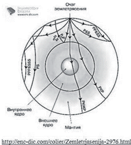
Рис. 1.16. Упрощённая схема распространения сейсмических волн в Земле [81].
