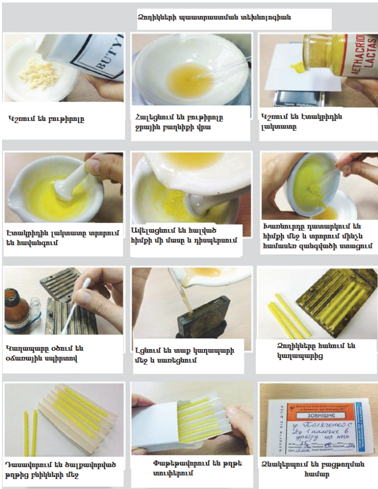
Նկար 14. Ձողիկների պատրաստման տեխնոլոգիան լցման մեթոդով
