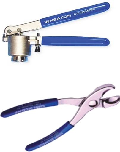
Նկ. 15. Weathon ապրանքանիշի ձեռքի ալյումինե կաղապարների փակող և բացող հարմարանքներ
