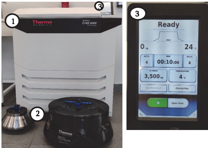
Նկ. 7. 1. Thermo Fisher Scientific Sorvall Lynx 6000 մականիշի լաբորատոր ցենտրիֆուգ, 2. ռոտորներ, 3. կառավարվող վահանակ
