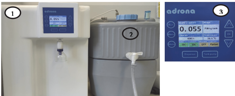
Նկ. 4. Գերմաքուր ջրի ստացման համակարգ 1. Grade 1, 2. Grade 2, 3. կառավարվող վահանակ
