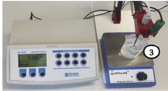
Նկ. 8. Բոնաչափիչ սարքեր (Hanna Instruments) և դրանց միացված՝ 1. ՕՎՊ (HI131, Hanna Instruments), 2. կալիումի իոնների ընտրողական (HI4114, Hanna Instruments) և 3. pH (HI1131, Hanna Instruments) էլեկտրոդներ
