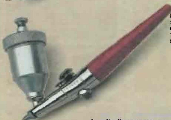
Рис. 31. Этот одинарного действия аэрограф «Paasche eraser» распыляет абразивный порошок.
