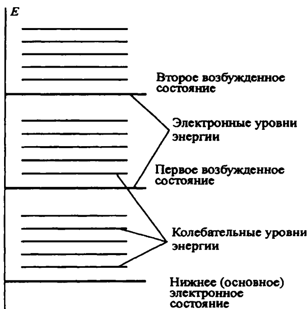
Рис. 4.1. Схематическое расположение электронно-колебательных уровней энергии многоатомной молекулы
