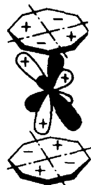
Рис. 11.21. Иллюстрация связывающего взаимодействия f -АО центрального атома урана с \pi -МО двух [8] -аннуленов в молекуле ураноцена
