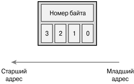
Рис. 19.2. Прямой порядок следования байтов
