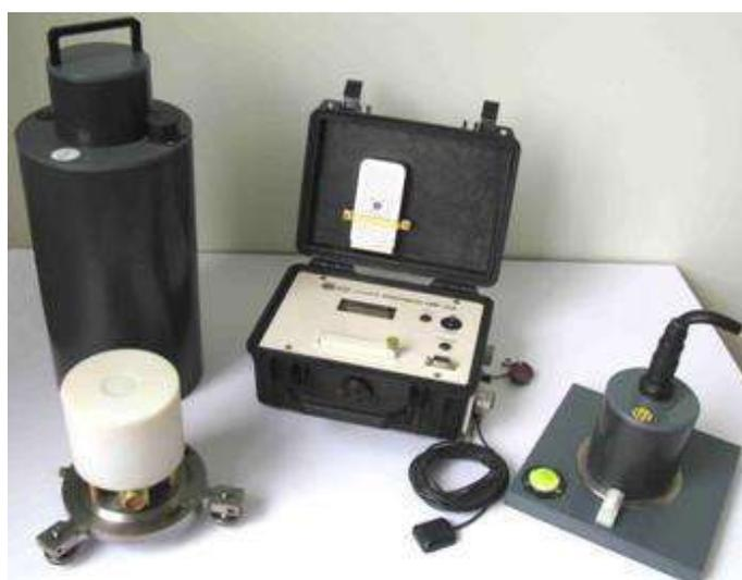
Рис. 3.13. Трёхкомпонентный феррозондовый магнитометр LEMI-018. [www.isr.lviv.ua]
