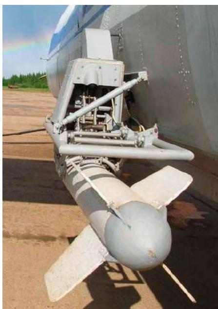
Рис.5.5. Выпускное оборудование (порт) и гондола. [aerogeo.ru].
