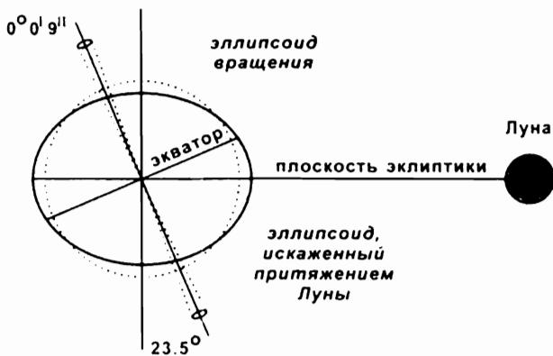
Рис. 9.3. Схема образования нутации земной оси
