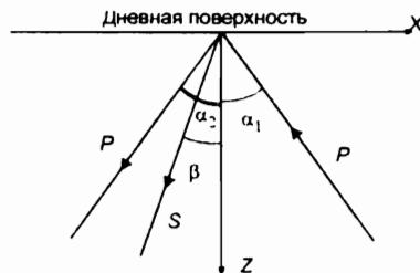
Рис. 4.5. Отражение продольной волны от дневной поверхности
