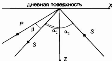
Рис. 4.6. Отражение поперечной волны от дневной поверхности
