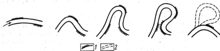
Рис. 6.20. Схема смещения и изменения формы излучины
