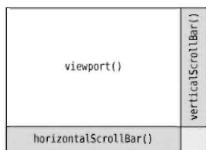
Рис. 6.12. Изменение размеров области с прокруткой QScrollArea
