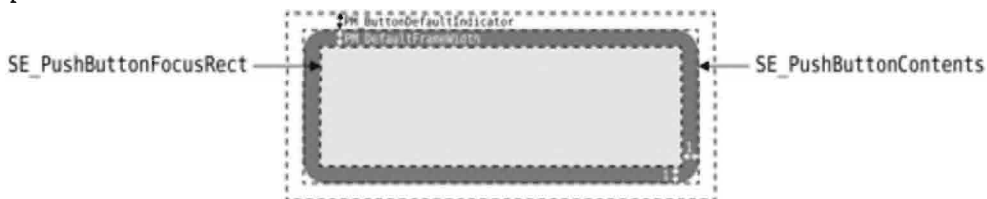
Рис. 19.19. Структура элемента QPushButton
