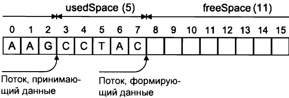
Рис. 14.2. Модель взаимодействия двух потоков: формирующего и принимающего данные
