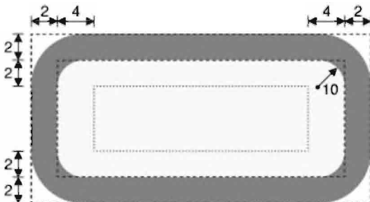
Рис. 19.8. Структура элемента QLineEdit
