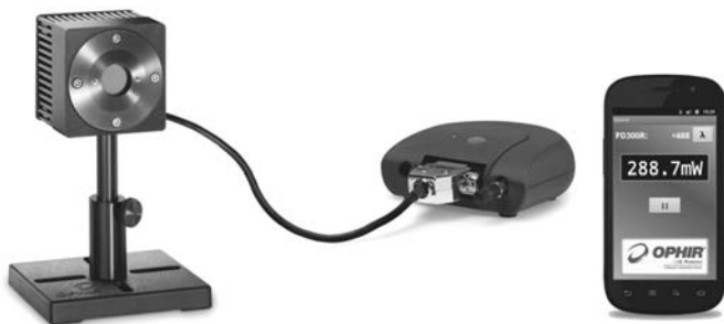
Рис. 2.16 Измеритель мощности и энергии лазерного излучения компании Ophir в составе (слева направо) измерительной головки с фотоприемным сенсором, вычислительного блока и средства отображения
