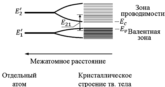
Рис. 7.1 Образование энергетических зон в кристалле
