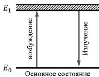
Рис. 1.12 Двухуровневая энергетическая схема
