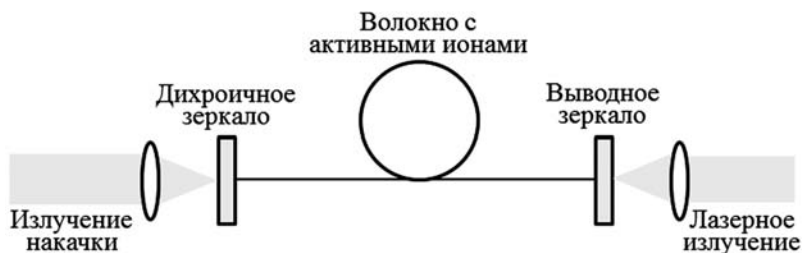
Рис. 6.16 Конструктивная схема волоконного лазера
