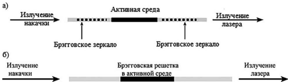
Рис. 6.20 Схема волоконного лазера:
