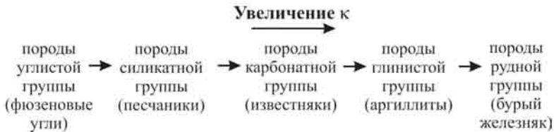
Рис. 25. Тенденция изменения магнитной восприимчивости у осадочных пород для одноименных стадий их преобразования ( \kappa (каппа) – магнитная восприимчивость)
