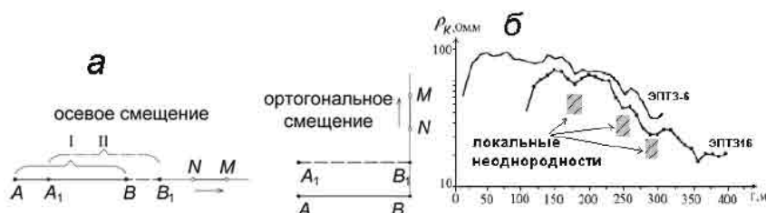
Рис. 179. Схемы полевых измерений ортосековыми установками ЭПТЗ (а), форма этих кривых, сопоставленных по соседним точкам в полулогарифмическом масштабе на предмет выявления и изучения неоднородностей (б)
