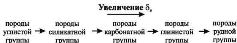
Рис. 13. Тенденция изменения плотности осадочных пород при одинаковой степени их преобразования (окаменения)
