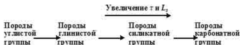
Рис. 97. Тенденция изменения нейтронных показателей для групп осадочных пород различной литологической принадлежности при однокименной стадии их преобразования
