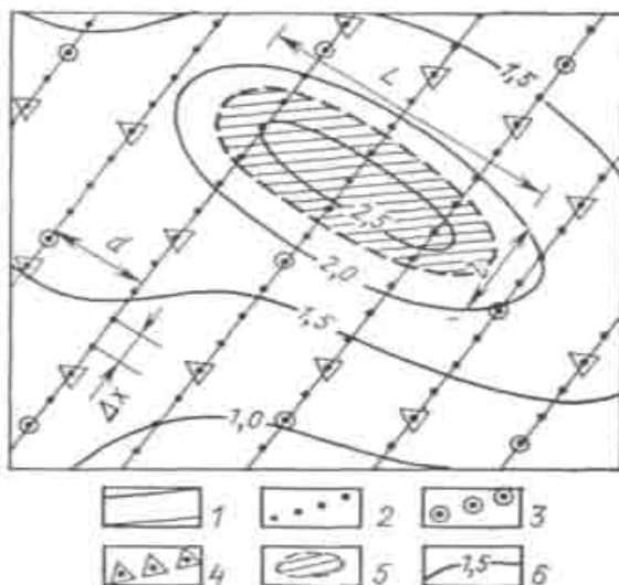
Рис. 15. Пример расположения геофизических профилей при гравитационной съемке:
