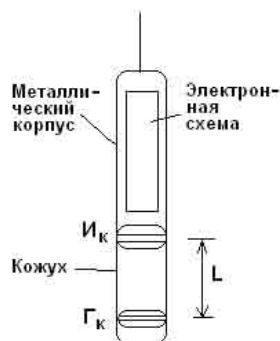
Рис. 119. Схема скважинного прибора индукционного каротажа
