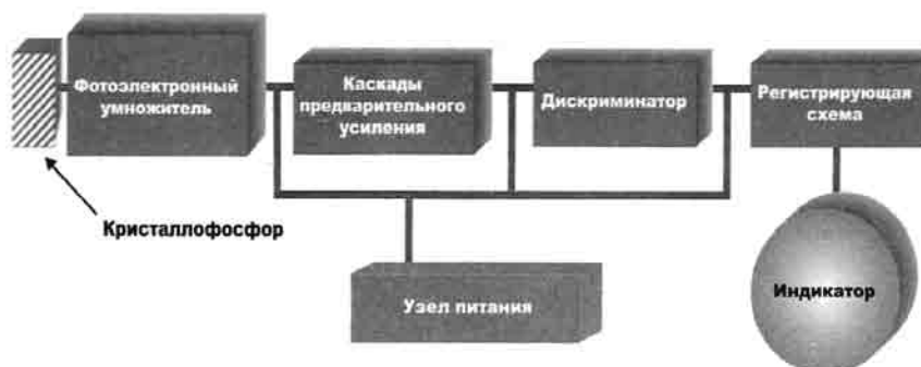
Рис. 101. Типовая блок-схема радиометров, используемых при ядерно-геофизических наблюдениях
