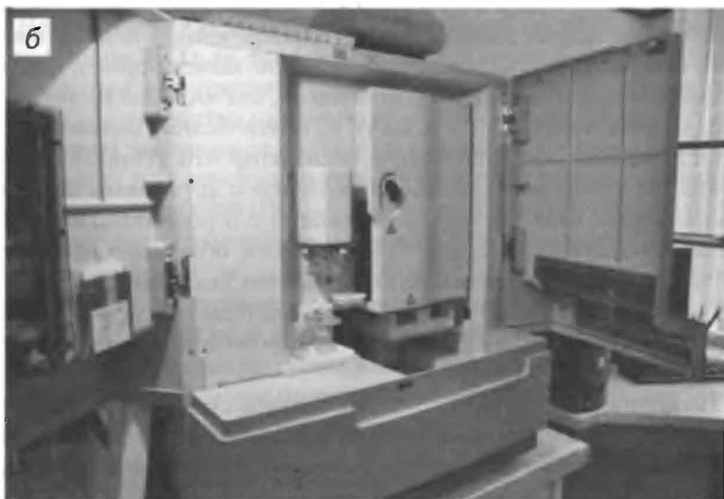
Рис. 11.3. Секвенаторы: а) ALFexpress II, осуществляющий электрофорез в пластинах геля («GE Healthcare», Великобритания); б) 4-х капиллярный секвенатор ABI Prism 3130 («Applied Biosystems», США)
