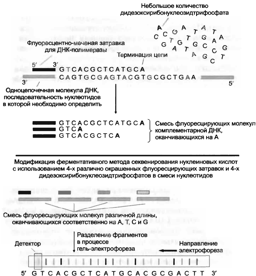
Рис. 11.2. Принцип ферментативного метода секвенирования ДНК
