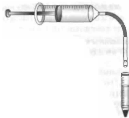
Рис. 12.1. Простое приспособление для сбора образцов природных осадков с целью последующего извлечения из них нуклеиновых кислот
