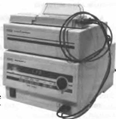
Рис. 4.4. Кюветы для электропорации «Gene Pulser» с электродами из алюминия («Bio-Rad», США) и схема электропоратора со вставленной кюветой
