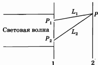
Рис. 11.3 Применение интерферометра Юнга для измерения степени пространственной когерентности электромагнитной волны между точками P_1 и P_2
