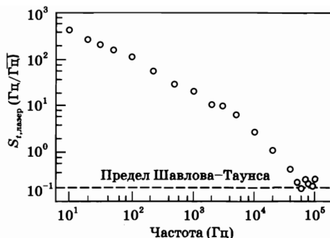
Рис. 7.28 Спектр частотного шума для Nd:YAG лазера с накачкой лазерными диодами, работающего в режиме свободной генерации (согласно работе [26])
