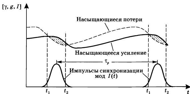
Рис. 8.24 Модель синхронизации мод с медленным насыщающимся поглотителем (представлена во временной области).
