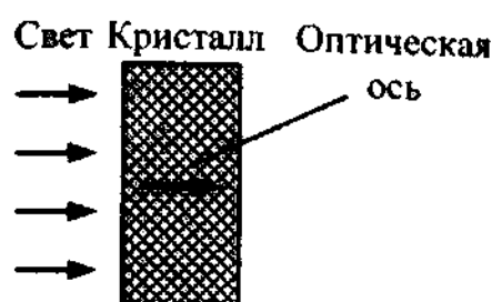
Рис. 13.4.1. Свет распространяется в кристаллической пластинке, вырезанной перпендикулярно оптической оси
