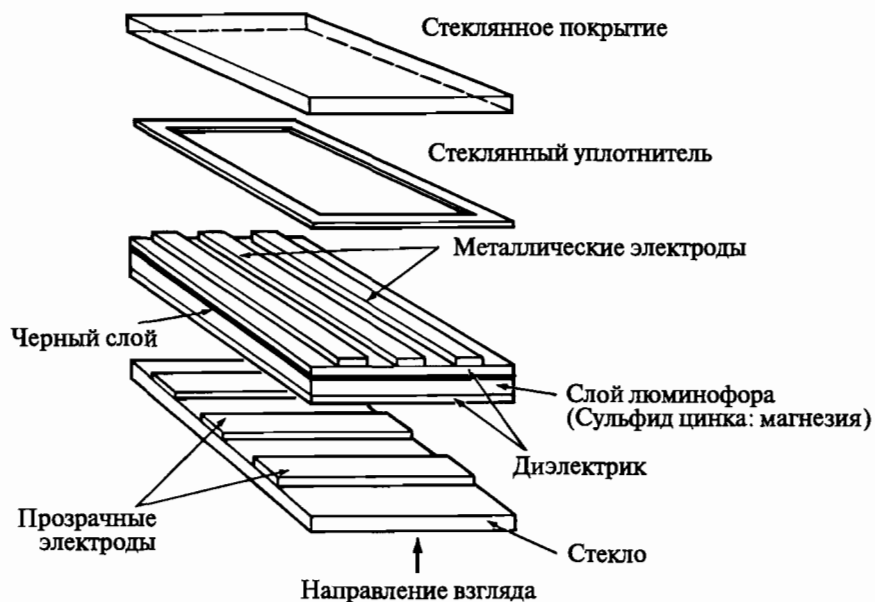
Рис. 1-39 Принципиальная схема электролюминесцентного дисплея типа АС.
