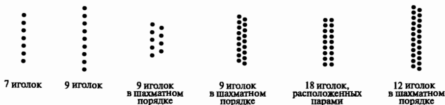
Рис. 1-52 Образцы размещения иголок в матричном печатающем устройстве.
