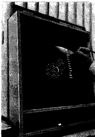
Рис. 1-15 С помощью выбора из меню световое перо используется для моделирования функции логической кнопки. (С разрешения фирмы Adage.)
