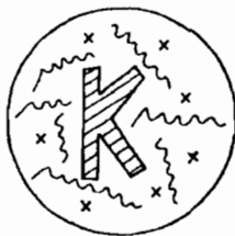
Рис. 12.18. Принцип оптической манипуляции реакции Белоусова—Жаботинского—Кунерта. Крестиками обозначены выходные электроды
