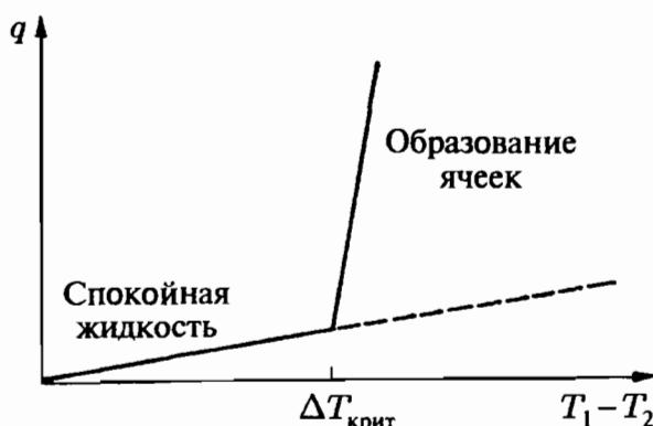
Рис. 4.12. Характерный излом в количестве переносимого тепла при переходе от теплопроводности к конвекции
