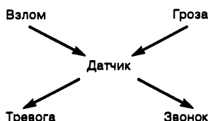
Рис. 15.4. Байесовская сеть. После взлома и проникновения в дом постороннего лица, по всей вероятности, происходит активизация датчика. Предполагается, что датчик активизирует звуковой тревожный сигнал и автоматический телефонный звонок с предупреждающим сообщением. Датчик может также сработать под действием сильной грозы
