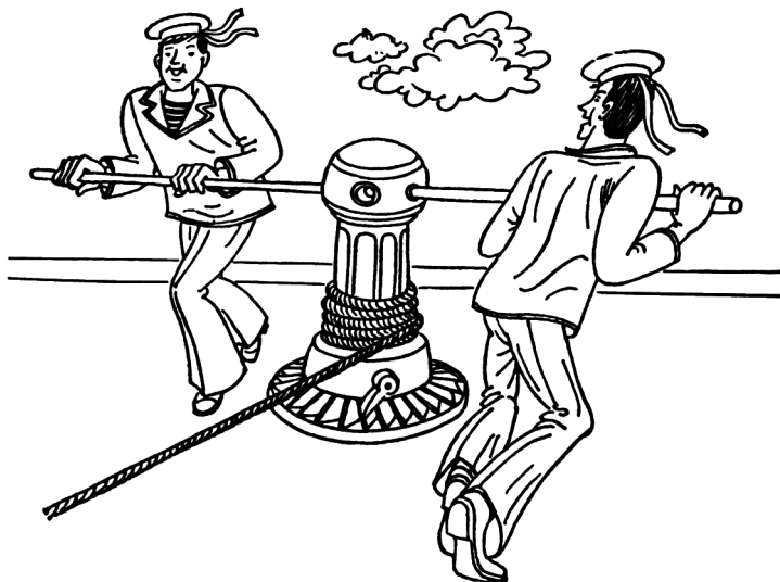
Рис. 144. Вертикальный ворот (кабестан)
