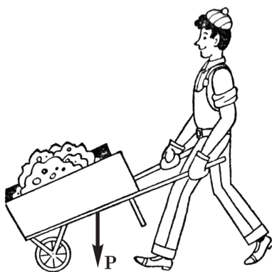
Рис. 139. Тачка как рычаг
