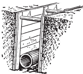
Рис. 460. Бревна А, удерживающие грунт от осыпания, находятся в состоянии сжатия
