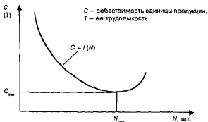
Рис. 2.4. Зависимость между себестоимостью (трудоемкостью) изготовления объекта и масштабом (годовой программой) его производства
