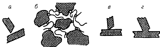
Рис. 10.18. Виды контактов в пространственных дисперсных структурах: а, б — коагуляционные с низкомолекулярными (а) и высокомолекулярными (б) слоями; в — точечные; г — фазовые контакты.
