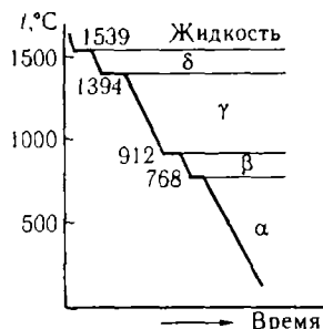
Рис. 26.1. Кривая охлаждения железа.
