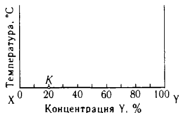
Рис. 12.5. Координаты для построения диаграммы состояния системы, состоящей из двух металлов.
