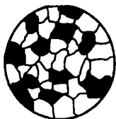
Рис. 12.2. Микроструктура сплавов двух металлов, образующих механическую смесь.
