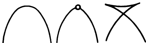
Рис. 4. Перестройка сечений ласточкина хвоста
