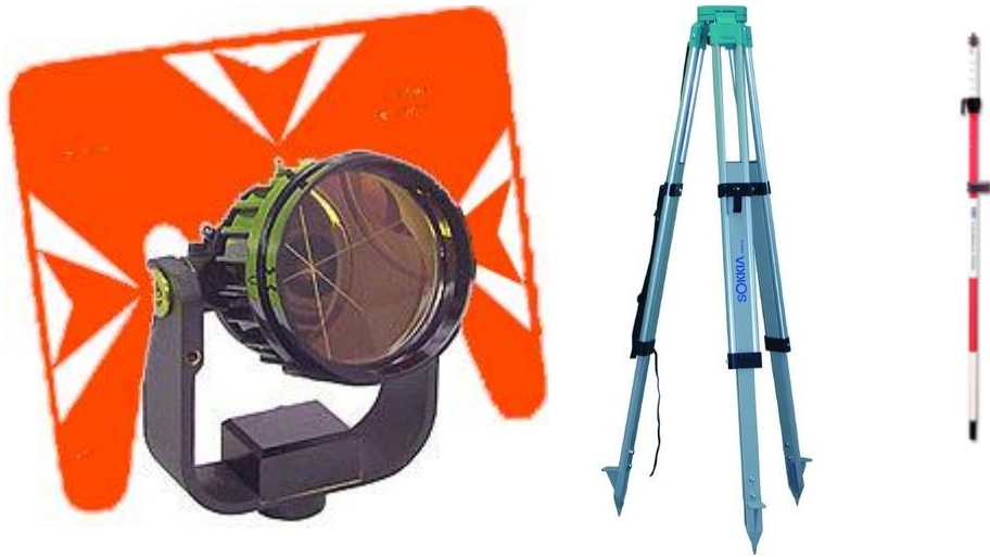
Նկ. 5.22. Պրիզմային անդրադարձիչ, այլումնեն եռոտոնի ու նշաձող
