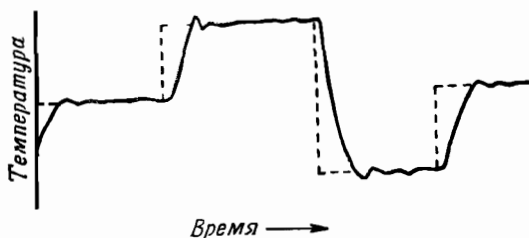
Ф и г. 14. Кривая температуры термостата (сплошная линия) при изменениях установки регулятора (пунктирная линия).
