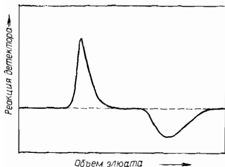
Рис. 16.7. Схема элюции для определения равновесного связывания лиганда с белком.
