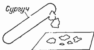
Рис. 21. Притяжение незаряженных кусочков бумаги к заряженному сургучу
