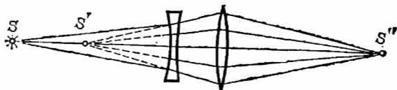
Рис. 202. Превращение расходящегося пучка лучей в сходящийся с помощью вспомогательной собирающей линзы (например, глаза)
