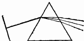
Рис. 190. Разложение белого света при преломлении в призме. Падающий пучок белого света изображен в виде фронта с перпендикулярным к нему направлением распространения волн. Для преломленных пучков показаны только направления распространения волн
