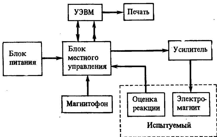
Рис. 2. Схема эксперимента по сенсорной индикации магнитных полей
